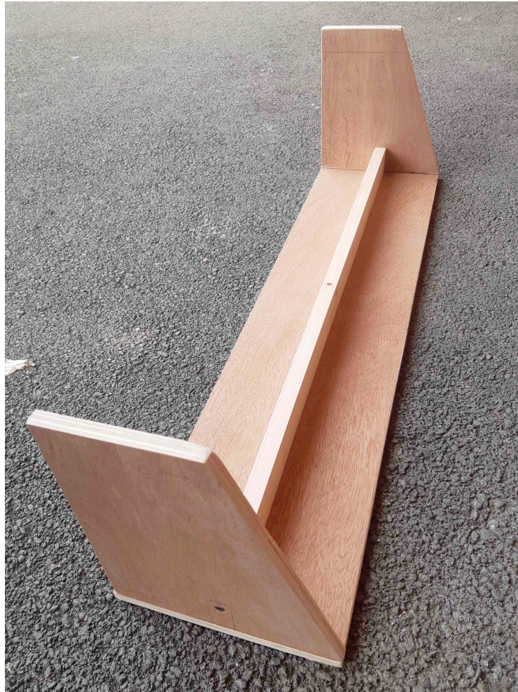
Figure 3. Etat d'avancement du tableau après avoir vissé le premier tasseau et les deux trapèzes rectangles.
